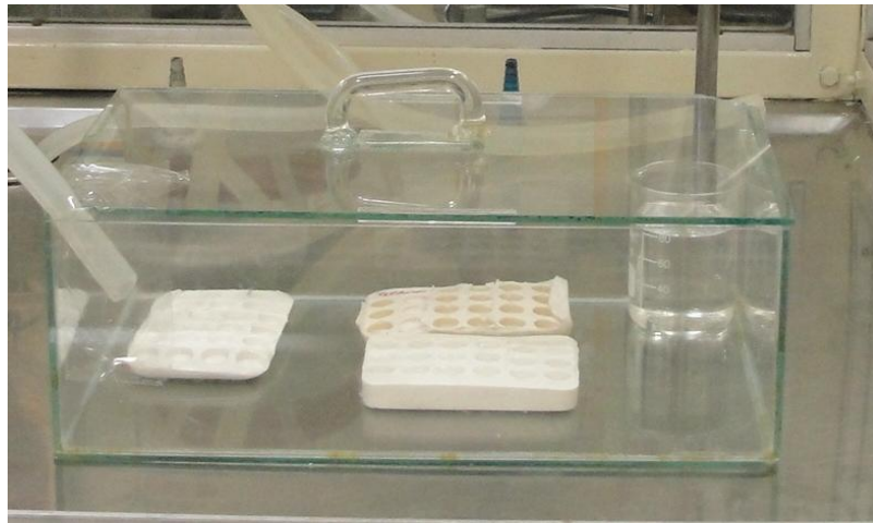
Fig.07 Solução do PLGA e rhGH na câmara de evaporação de solvente com a mangueira de N 2 acoplada.
