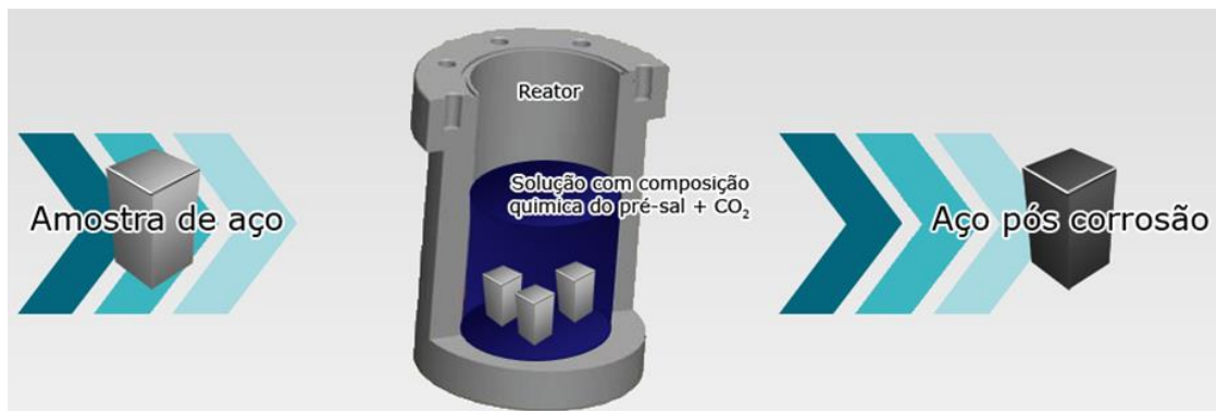
Figura 4.2. Desenho esquemático do reator com as amostras de aço, em corte longitudinal.
