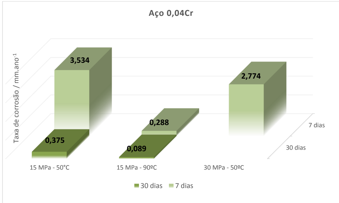
Figura 5.13. Taxas de corrosão obtidas, em todos os ensaios, para o aço microligado com 0,04Cr.
