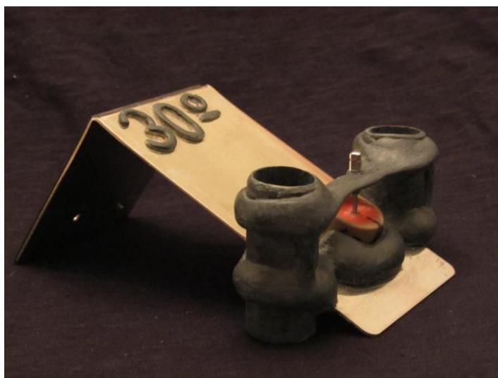
Figura 4: Posicionador de implantes utilizado, com inclinação de 30° em relação ao solo.
