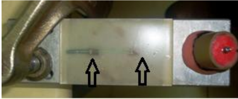
Figura 8: célula de carga utilizada, observar 2 extensômetros (onde estão as flechas) de resistência elétrica (strain gages) de 350 ohms, os outros ficam no lado oposto. Fonte: o autor (2012).
