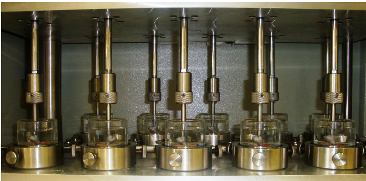
Figura 10: corpos de prova inseridos no Simulador de Fadiga Mecânica ERIOS.
