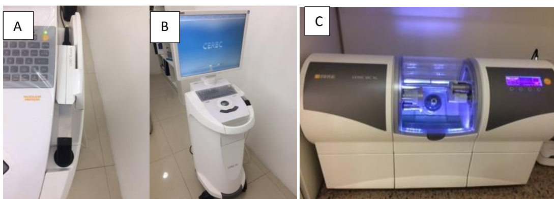
Figura 1 - Dispositivos CAD, de captura e desenho, e fresagem CAM. A) Câmera intra oral para digitalização do preparo dentário. B) Programa de desenho assistido por computador com imagens em 3D (CAD). C) Fresadora (CAM). Fotos da autora.
