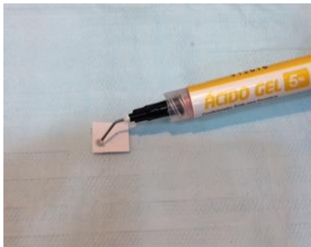
Figura 7 - Aplicação de ácido fluorídrico 5% no corpo de prova de cerâmica de silicato de lítio reforçada por zircônia Suprinity
