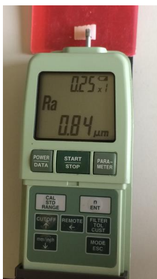
Figura 12 - Teste de Rugosidade Superficial realizado no rugosímetro Mitutoyo SJ-201.
