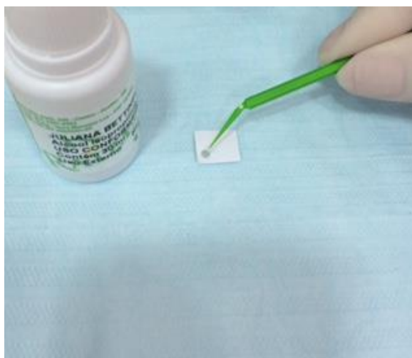
Figura 6 – Aplicação de álcool isopropílico 10% no corpo de prova de resina nanocerâmica Lava Ultimate
