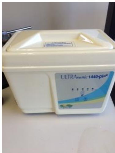
Figura 10 – Limpeza dos corpos de prova em cuba ultrassônica por 20 minutos em água destilada
