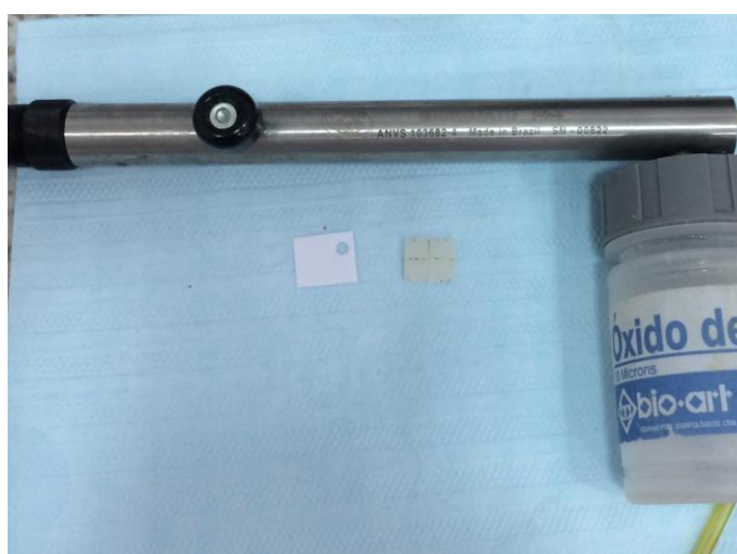
Figura 5 - Jato de Óxido de Alumínio, delimitador de área e corpo de prova de cerâmica híbrida Enamic
