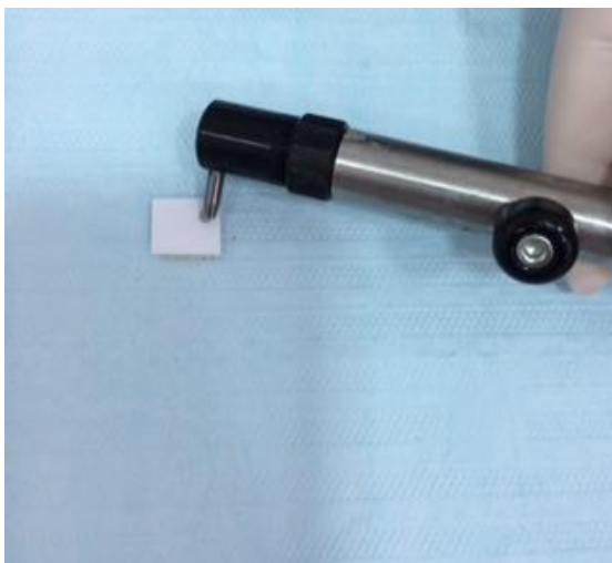
Figura 9 - Aplicação do jato de óxido de alumínio no corpo de prova de cerâmica vítrea com estrutura cristalina de dissilicato de lítio E.max
