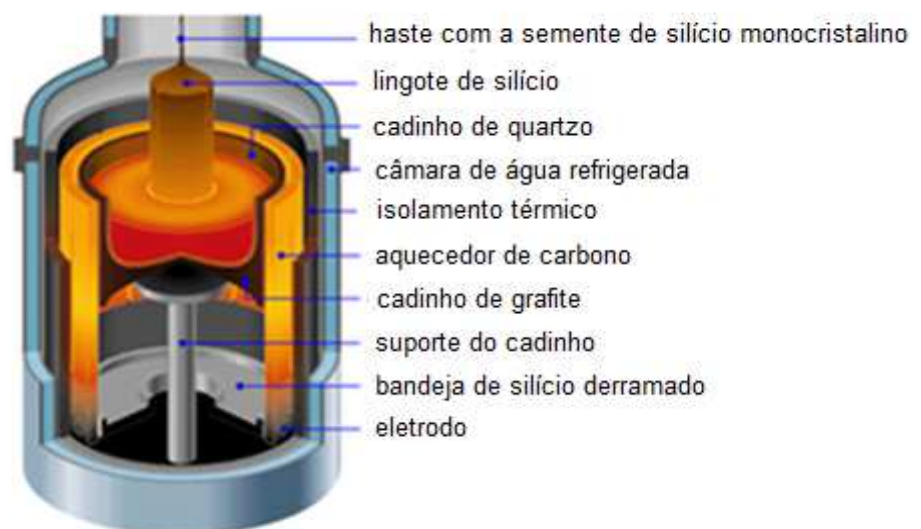
Figura 2.1. Esquema do forno para obtenção de silício monocristalino pelo método Czochralsky. (Adaptado de Jones, 2011).
