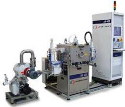
Figura 3.7. Equipamento PECVD utilizado para deposição do filme de SiNx na UPM.
