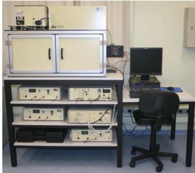
Figura 3.17. Equipamento utilizado para medida da resposta espectral.
