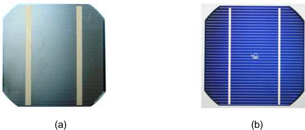
Figura 3.8. (a) Malha metálica na face posterior que forma o campo retrodifusor seletivo e (b) malha metálica frontal.
