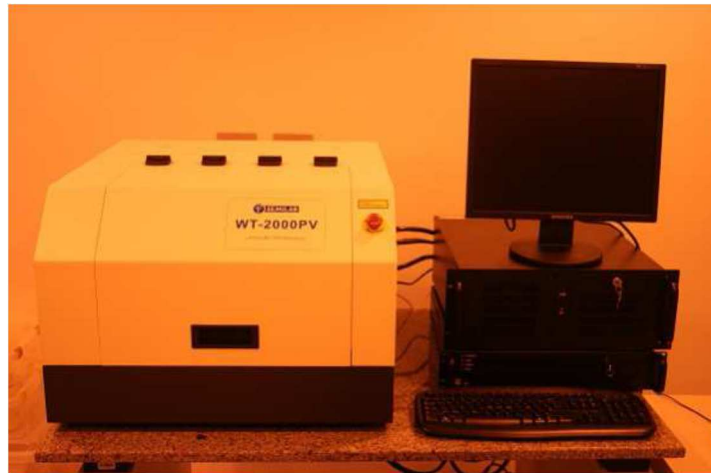
Figura 3.20. Equipamento WT-2000 usado para a medição do tempo de vida e do comprimento de difusão dos portadores de carga minoritários com as técnicas \mu -PCD e LBIC, respectivamente.
