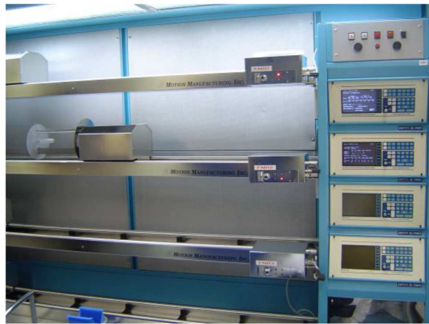
Figura 3.5. Forno convencional para difusão de boro e fósforo e oxidação.
