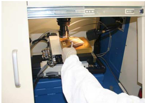
Figura 3.13. Porta amostra do sistema laser.
