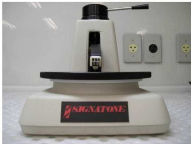
Figura 3.14. Equipamento de 4 pontas usado para medição da resistência de folha.
