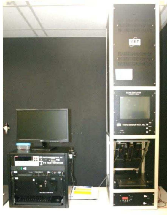
Figura 3.15. Simulador solar e sistema automatizado para medição de parâmetros elétricos das células solares, sob condições padrão.
