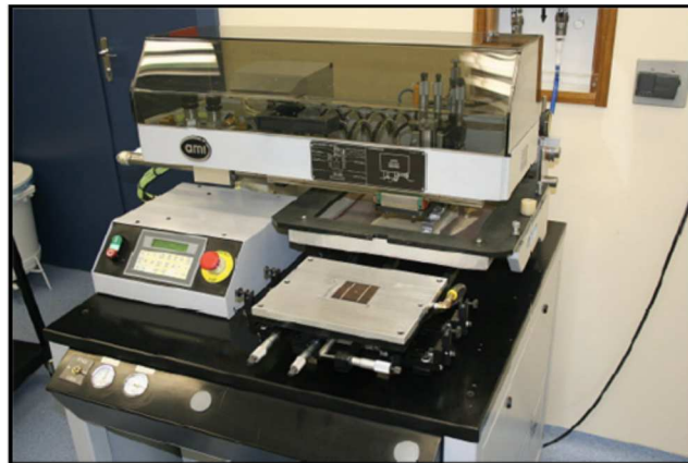
Figura 3.9. Equipamento usado para deposição da malha metálica por serigrafia.
