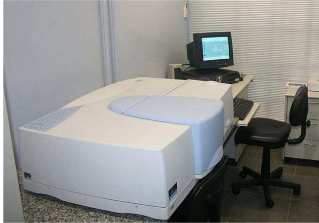
Figura 3.18. Espectrofotômetro lambda 950 usado para medida da refletância.
