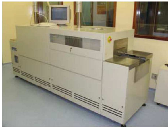
Figura 3.11. Forno de esteira utilizado para secagem e queima das pastas metálicas.
