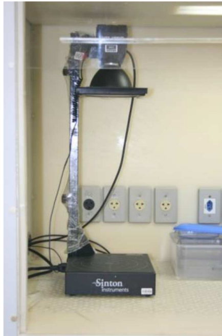
Figura 3.19. Equipamento WCT-100 utilizado para medição do tempo de vida dos portadores de carga minoritários.
