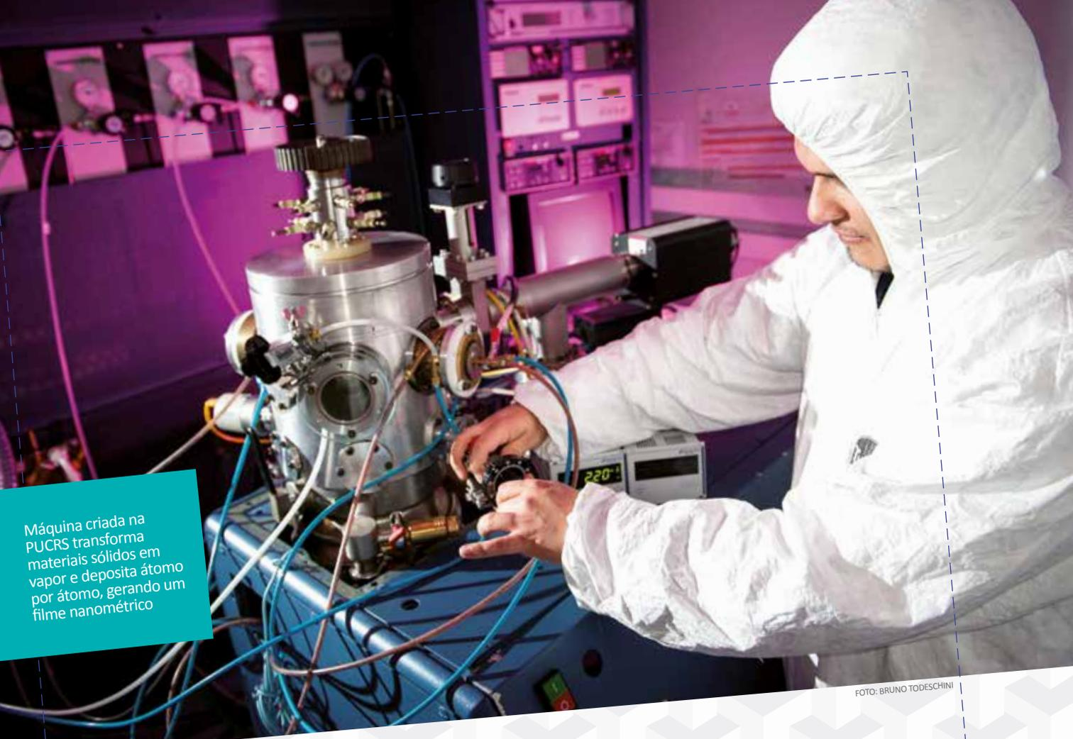
Máquina criada na PUCRS transforma materiais sólidos em vapor e deposita átomo por átomo, gerando um filme nanométrico
