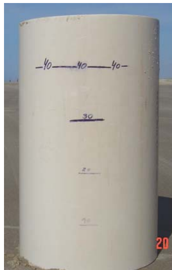
Figura 06: Amostrador cilíndrico utilizado para a execução das unidades amostrais.
