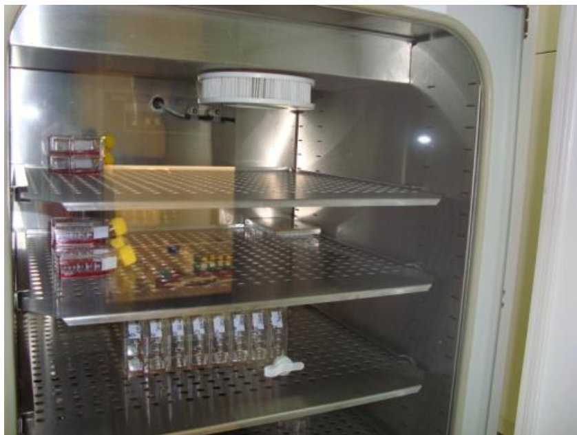
Figura 4: Incubadora de CO 2 , a qual mantém a temperatura de 37° C, com 5% de CO 2 e 95% de O 2 Fonte: O autor (2010)
