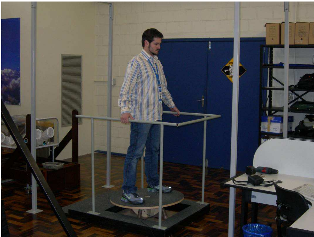
Figura 4.2 b – Teste da plataforma de força com sistema de amortecimento
