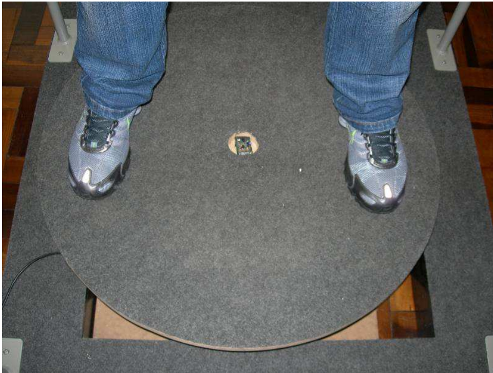
Figura 4.2 a – Teste da Plataforma de força e placa de acelerômetro
