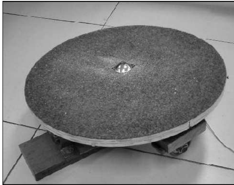
Figura 3.5 – Segundo protótipo – base, acelerômetro e dispositivo de frenagem Fonte: www.pucrs.br/feng/microg
