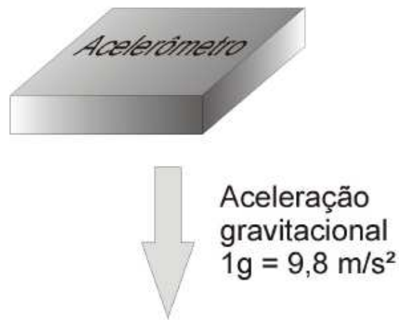
Figura 3.16 - Orientação correta para calibração em +g Fonte: Databook Freescale Semiconductor
