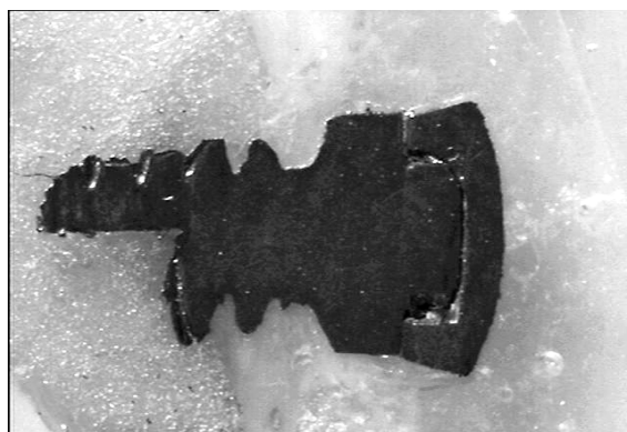
Figura 3.5 - Amostra metálica embutida em resina para observação no MEV (cortesia IPCT-PUCRS).
