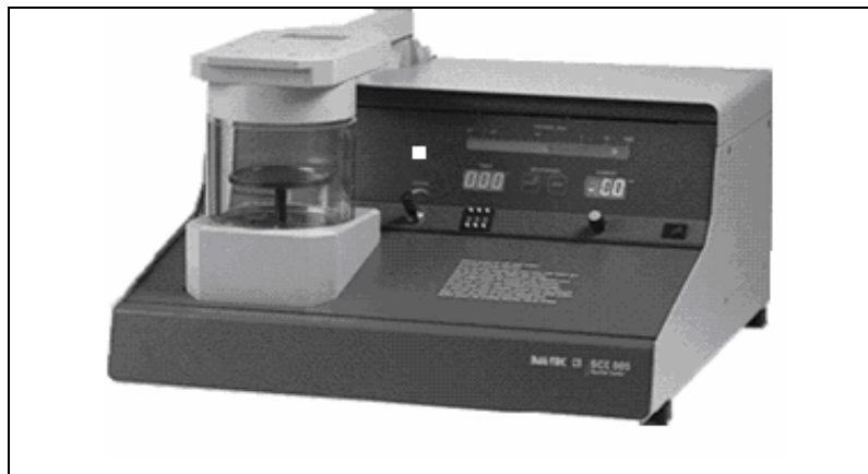
Figura 1.13 - Equipamento utilizado para recobrimento com carbono ou deposição metálica sobre as amostras não condutoras.
