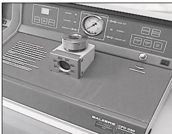
Figura 1.12 - Equipamento de ponto crítico utilizado para secagem de amostras biológicas.
