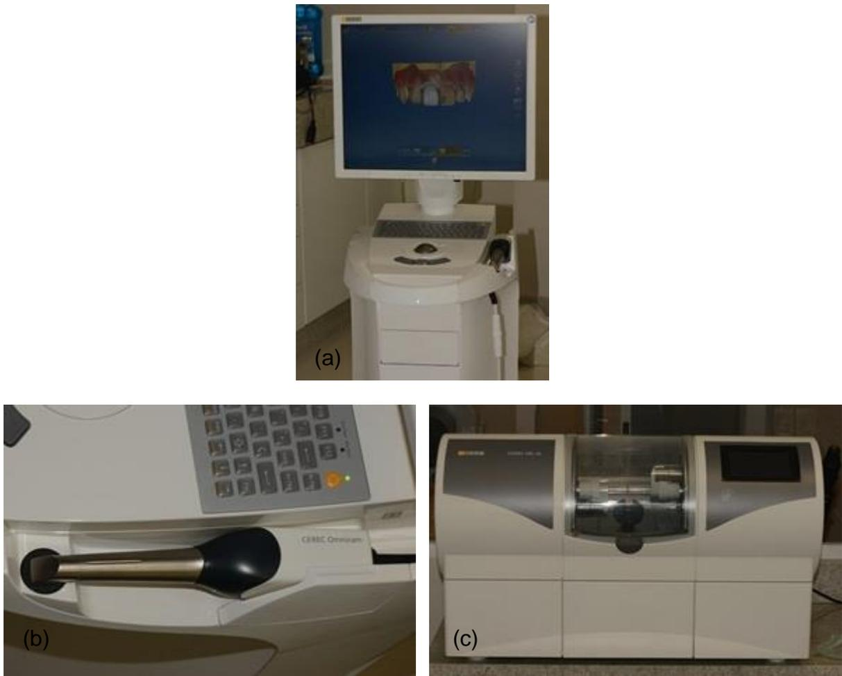
**Figura 9 – Foto do sistema CEREC, AC Ominicam vista geral (a), vista aproximada Ominicam (b) e Fresadora MC XL (c).**
