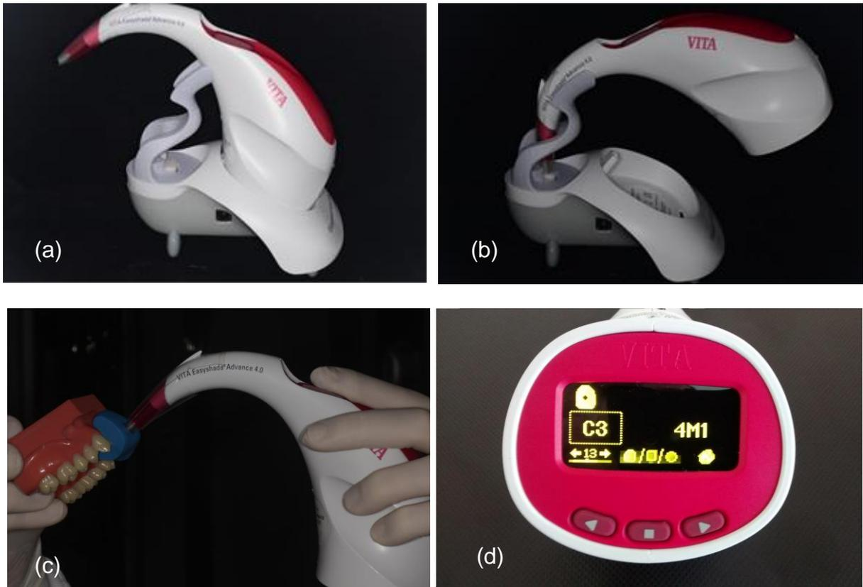
**Figura 3 – Espectrofotômetro (a), calibração do instrumento (b), posicionamento para tomada de cor com a guia de silicone de condensação (c) e visor (d).**
