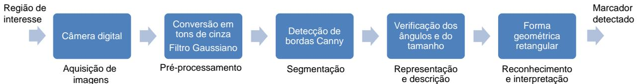
Figura 41 – Etapas do subsistema visual alinhadas aos passos fundamentais de um sistema de visão computacional. Fonte: o autor.
