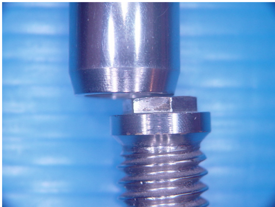
Figura 23 - Presença (simulação) de fenda horizontal
