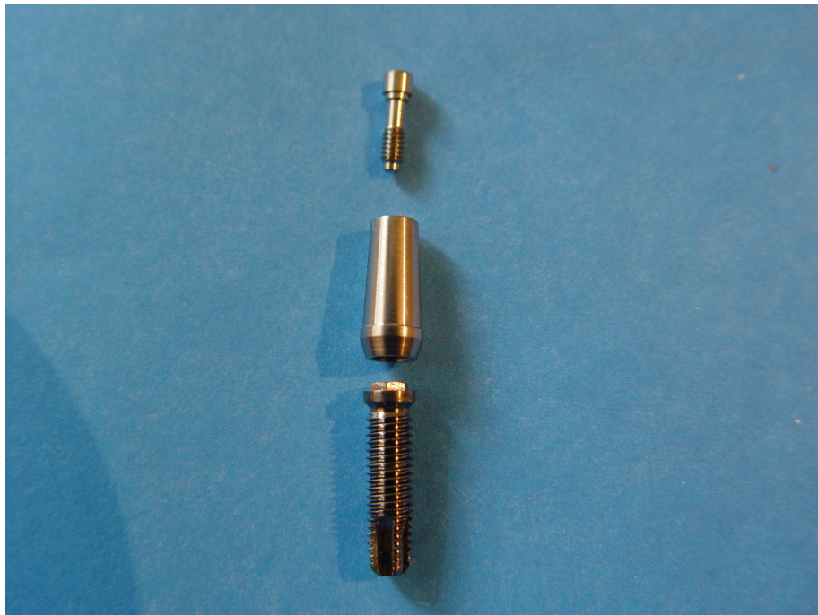
Figura 04 - Simulação de encaixe dos componentes para avaliação de desadaptação, de cima para baixo (Parafuso de Titânio 4.1 para fixação de UCLA, Componente Munhão Personalizado e Implante)
