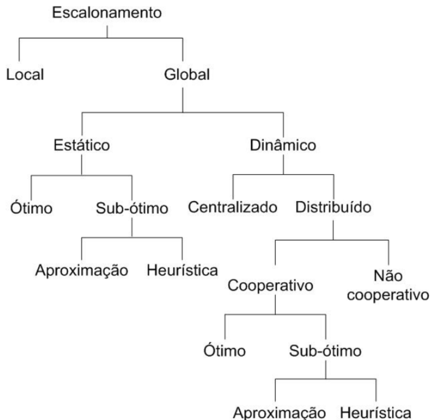
Figura 1 – Taxonomia hierárquica para algoritmos de escalonamento em sistemas computacionais paralelos e distribuídos. Adaptado de [CAS88].
